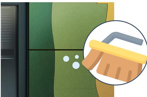
Vor der Montage sind Staub (z. B. aus Zuschnitt, Vorbohren oder Kantenbrechung) oder anderweitige Verunreinigungen von den Fassadenplatten vollständig zu entfernen.
